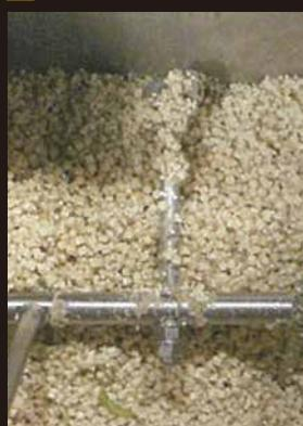
ほぼ生分解処理が完了した状態。（食材により生分解が終了するまでの時間差があります。）
