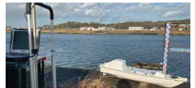
ラジコンボートの自動運転による深浅測量
